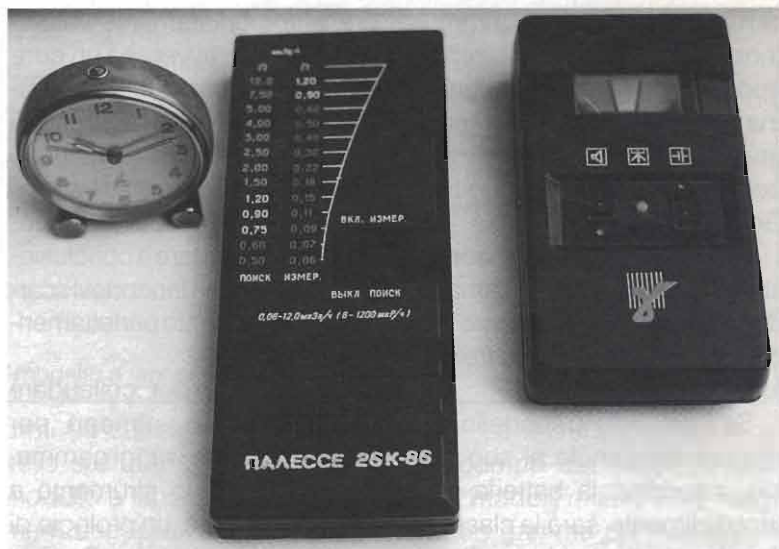
Foto 2 - Modelli a indicazione analogica, che misurano solo raggi gamma. A sinistra il modello a barra di LED 26K-86 e a destra quello a lancetta. Il piccolo orologio è un oggetto databile verso la fine degli anni '40 e rappresenta il test per raggi gamma.... la sua emissione resta molto bassa, ma è sensibilmente più alta della normale radioattività naturale.
